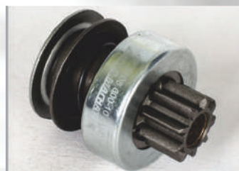
Привод стартера (бендикс) 42.3708.600-10 Стартер 42.3708000-10 (ХН-949)
