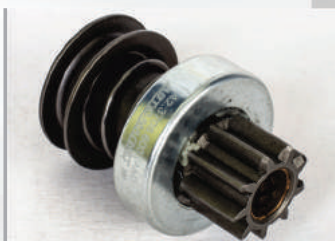
Привод стартера (бендикс) 42.3708.600 Стартер 42.3708000, 421.3708000-01, 422.3708000 (ХН-006)
