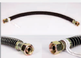
Шланг тормозной 6422-3506085-01 (ГАЙКА-ГАЙКА) В СТАЛЬНОЙ ОПЛЕТКЕ МАЗ подводящий к влагоотделителю L=605мм Норма упаковки, (шт.) - Вес, (кг.) ..... - 0,45
