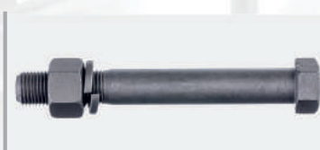
Болт рессоры 291156-П29СБ (АМ-46-028) ГАЗель в сб. (гайка + гровер) (М16х1.5х120, SW22, TL:38, 10.9 класс, тефлон) (291156-П29) Норма упаковки, (шт.) - 10/50 Вес, (кг.) ..... - 0,26
