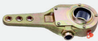
Рычаг регулировочный A3820 КАМАЗ прицепа СЗАП-93271А полуавтоматический Норма упаковки, (шт.) - 10 Вес, (кг.) ..... - 2,20
