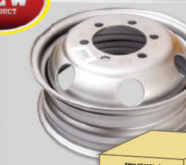
Диск колеса 3302-3101015 (16x5,5) (1350 кг) ГАЗ-3302 (16x5.5) усиленный (нагрузка до 1350 кг) (в фирменной картонной упаковке) Норма упаковки, (шт.) - 1 Вес, (кг.) ..... - 13,7
