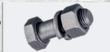
Болт 301028-СБ (АМ-46-030) Болт М14х1.5х40 Г-3309, 3310, ЗИЛ-130, 5301 крепления вала карданного в сборе с гайкой и шайбой тефлон 10.9 класс (комплект 4шт) (состав комплекта: 301028 + 250559 + 252138) Норма упаковки, (шт.) - 1/50 Вес, (кг.) ..... - 0,37
