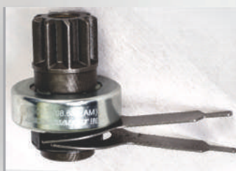
Привод стартера (бендикс) 6502.3708.600
