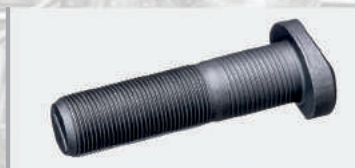
Болт A0004014171 (АМ-46-032) Болт колеса заднего (шпилька) КАМАЗ 5490, MERCEDES Actros, Axor (М 22х1.5х102/91/57) (аналог: 100.276 , 4.40205) Норма упаковки, (шт.) - 10/50 Вес, (кг.) ..... - 0,32
