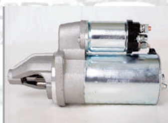
Стартер 5732.3708 (12В/1,7кВт/9 зубьев) УАЗ-469, 2206, 31514, 3960, дв. ЗМЗ-402,421, УАЗ дв. 4218, редукторный, ГАЗ, ВОЛГА (замена 62.3708 и 6002.3708, СТ 230-БЗ, ЗиТ 5732.3708) Норма упаковки, (шт.) - 4 Вес, (кг.) ..... - 4,30
