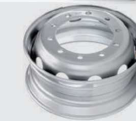
Диск колеса 167.510.3101012-21 (6.75-19.5) (AM-11-010) ГАЗон Next, ПАЗ-3204, 3237 HYUNDAI HD120, AeroTown (6.75-19.5) 6 шпилек (6,75x19,5 6 шпилек, PCD расстояний 222,25, ET135, DIA164 Норма упаковки, (шт.) - 1/20 Вес, (кг.) ..... - 30
