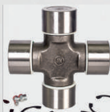
Крестовина карданного вала 6520-2201025-10 КАМАЗ «Евро-2», КАМАЗ г/п свыше 20 тонн, иномарки (47,6 x 135) Норма упаковки, (шт.) - 12 Вес, (кг.) ..... - 2,5
