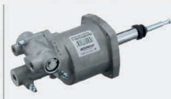
Пневмогидроусилитель 11.1602410-33 (AM-22-024) УРАЛ дв. ЯМЗ-536 алюминиевый корпус (аналог: 970 051 424 0, 160-15-017, VG3354, VG3356, 11.1602410-32)
