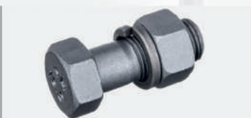
Болт 301028-СБ (АМ-46-030) Болт М14х1.5х40 Г-3309, 3310, ЗИЛ-130, 5301 крепления вала карданного в сборе с гайкой и шайбой тефлон 10.9 класс (комплект 4шт) (состав комплекта: 301028 + 250559 + 252138) Норма упаковки, (шт.) - 1/50 Вес, (кг.) ..... - 0,37
