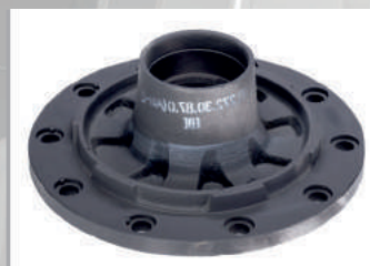
Ступица 03.272.30.87.0 HSF 9010ECO, BPW колеса оси HS, HZ ECO 6-9т (под подшипники 32310, 33116, d=281, h=194) (аналоги: M2200110, 070.098, 8300602SX, 300240, 1021BPW) Норма упаковки, (шт.) - 20 Вес, (кг.) ..... - 10,3
