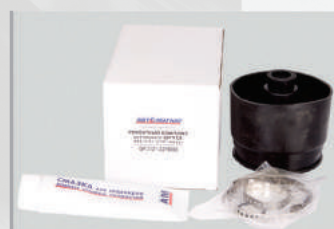
Ремонтный комплект наружного ШРУСА GP.2121-2215001 ВАЗ-2121-2123 «Нива» (пыльник, хомуты, кольцо стопорное, смазка)
