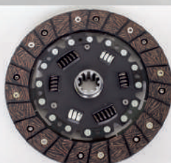
Диск сцепления ведомый 402-1601130 (225 мм)
