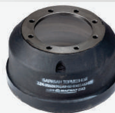
Барабан тормозной 224-3502070 (АМ-02-038) задний ПАЗ-4234, 320412-03, КАВЗ-4230, 4235 с канашским мостом (8 отверстий) Норма упаковки, (шт.) - 1 Вес, (кг.) ..... - 36,8
