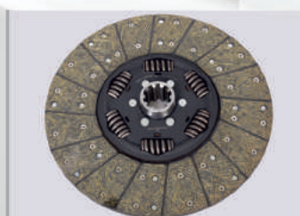
Диск сцепления ведомый 1878079306 (362 мм) МАЗ-4370 «Зубренок» ведомый (КПП-433420), МАЗ-4570 с дв. ММЗ 245.9 с КПП -433420 (аналог SACHS) 1878079306
