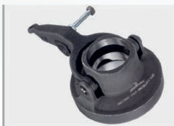
Муфта выключения сцепления 4301-1601180 ГАЗ-4301,3310 Валдай в сборе с вилкой
