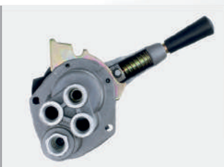
Кран 100-3537310 ЗИЛ, КАМАЗ, МАЗ стояночного тормоза 4-х выводной Норма упаковки, (шт.) - 20 Вес, (кг.) ..... - 1,16
