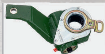
Рычаг регулировочный DZ90149346112 КАМАЗ-ЕВРО среднего моста ЛЕВЫЙ, (19 шлицов) SHAANXI HANDE Норма упаковки, (шт.) - 6 Вес, (кг.) ..... - 3,55
