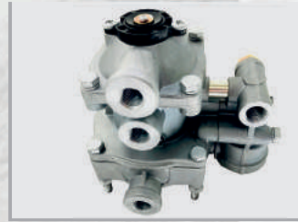
Клапан 9730025200 двухпроводный управления прицепа с клапаном обрыва и глушителем в сборе (аналог 64221-3522010) Норма упаковки, (шт.) - 10 Вес, (кг.) ..... - 2,00
