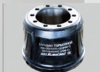
Барабан тормозной 0310946060 (AM-3501070-05) BPW полуприцепа (300x200/209 h=260 d=190/225) (аналог: OR842033, M1900186) Норма упаковки, (шт.) - 1 Вес, (кг.) ..... - 40,0
