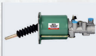
Пневмогидроусилитель VG-3208 (3268) МАЗ, КАМАЗ, ПАЗ (аналог KnorrBremse)
