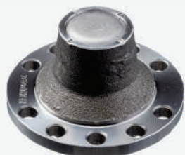
Фланец 3151-2407190 Фланец УАЗ-469 ступицы колеса заднего редукторного моста
