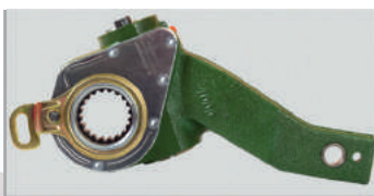
Рычаг регулировочный 79855 (AM-020-2202023) НЕФАЗ-5299 ЗАДНИЙ ЛЕВЫЙ (аналог MOM 2393-971) 20 зубов Норма упаковки, (шт.) - 6 Вес, (кг.) ..... - 3,55
