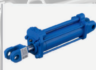
Гидроцилиндр AM.Ц75*200 Гидроцилиндр вилками (задней навески МТЗ, ЮМЗ, Т-40, подъем отвала, сеялки, культиваторы, грабли) (аналоги: С75/30Х200-3.44(515), Ц75*200-3, ГЦ 75.30.200.515.02 ) Норма упаковки, (шт.) - 1 Вес, (кг.) ..... - 16,00
