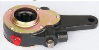
Рычаг регулировочный 120-3502136 (5320-3501136) ЗИЛ-130, ДЛИННЫЙ ЗАДНИЙ, ПАЗ, КАМАЗ ПЕРЕДНИЙ, (Аналог 5320-3501136) Норма упаковки, (шт.) - 10 Вес, (кг.) ..... - 1,70
