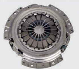
Диск сцепления нажимной (корзина сцепления) 2112-1601085 ВАЗ 2110, 2111, 2112
