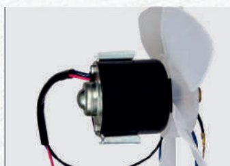
Мотор отопителя МЭ 255-04 (HW402A) 1 , (12В/20Вт) с крыльчаткой в сборе ВАЗ 2101-2107, 2121, 21213, 2131 «Нива», 1111 «Ока» (аналог 2101-8101080) Норма упаковки, (шт.) - 24 Вес, (кг.) ..... - 0,69
