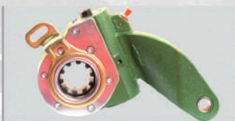
Рычаг регулировочный 80040 КАМАЗ-4326, 43502, 65111, 43118, 63501 ПЕРЕДНИЙ ЛЕВЫЙ АВТОМАТ (аналог 9201-3502011-10) 10 зубов Норма упаковки, (шт.) - 6 Вес, (кг.) ..... - 3,45
