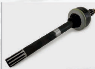
Шарнир поворотного кулака 469-2304060 УАЗ-3151, 469 правый короткий L=460mm (редукторный мост) смазка в комплекте
