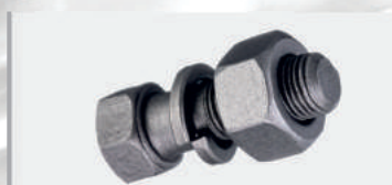
Болт (шпилька) колеса 0329633121 (АМ-46-049) ВРW (М22х1.5х97) дисковые тормоза 10.9 класс (тефлон) Норма упаковки, (шт.) - 10/50 Вес, (кг.) ..... - 0,34
