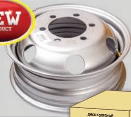
Диск колеса A21R23-3101015 (AM) (16x5.5) (1000 кг) ГАЗ-3302 (16x5.5) усиленный (нагрузка до 1000 кг) (в фирменной картонной упаковке) Норма упаковки, (шт.) - 1 Вес, (кг.) ..... - 13,0
