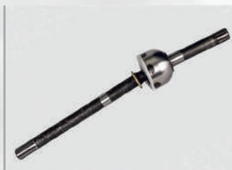
Шарнир поворотного кулака 3160-2304060 правый УАЗ-3160 мост «Спайсер» (колея 1445 mm) (аналог: 3160-2304060-95)
