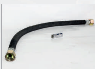
Шланг тормозной, 58 см 22.3506510 ГАЙКА / ГАЙКА Автобусы ЛиАЗ-5256, Лаз
